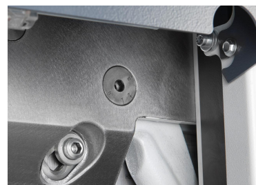
Jednoduché seřízení dořezu na přední části kulisy nože.
