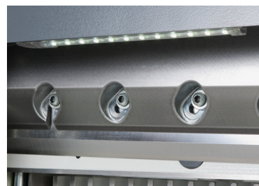
Osvětlení prostoru řezu LED diodami.
